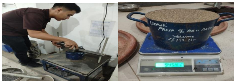
Gambar 4 pengujian berat isi Agregat kasar dan agregat halus
