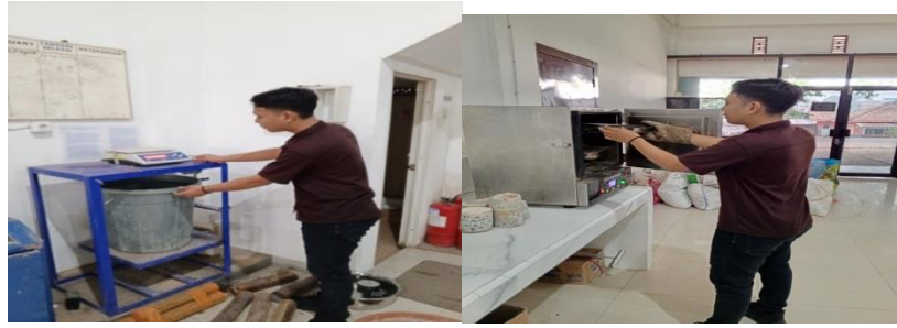
Gambar 5 pengujian berat jenis agregat kasar
