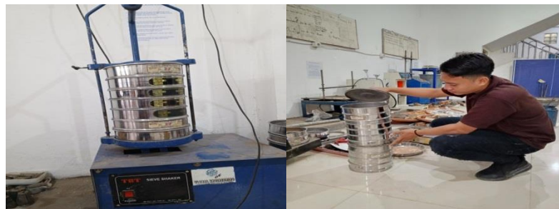
Gambar 3 Analisa Saringan agregat halus dan agregat kasar
