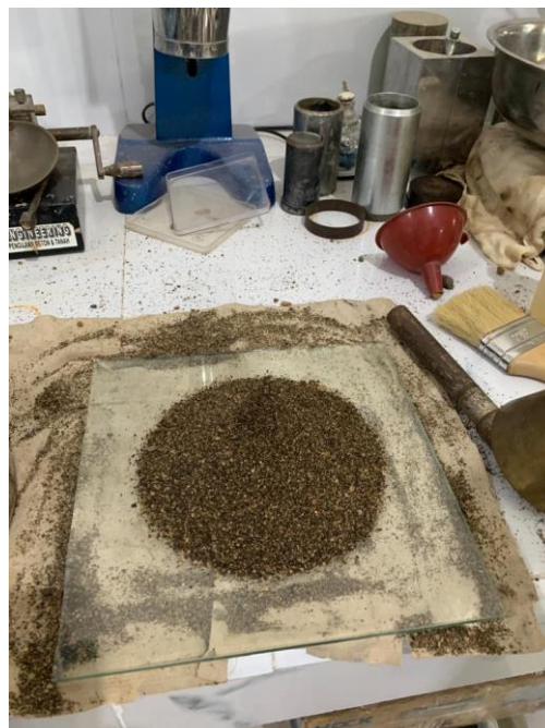
Gambar 6 Pengujian Berat Jenis ( Kondisi SSD )
