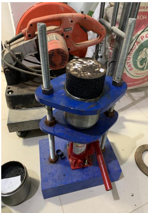
Gambar 13 Proses Pengeluaran Aspal
