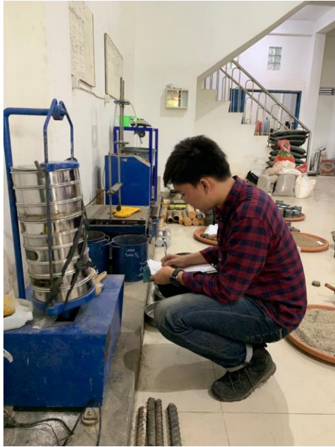
Gambar 7 Pengujian Analisa Saringan
